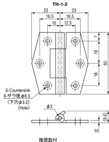
推奨取付 M3サラねじ又はサラリベット Recommended installation M3 countersunk screws or rivets
