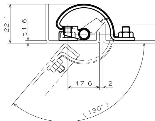
取付寸法例 (取付板厚 1.6mm)
