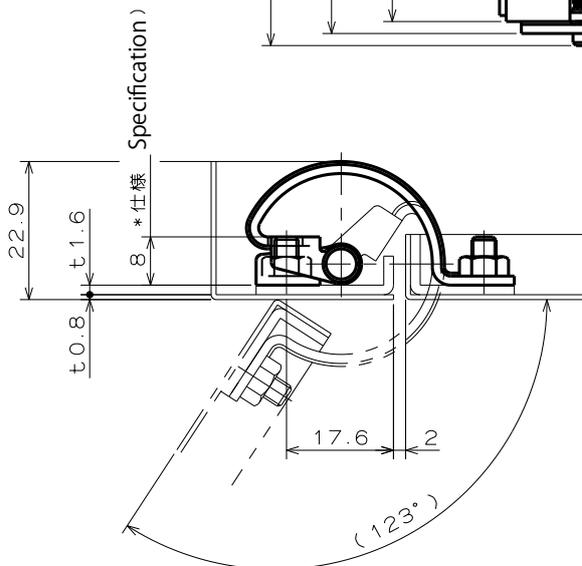
取付寸法例 (取付板厚 2.4mm)
