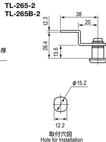
仕様 Specification TL-265：ナット取付タイプ / TL-265B：リテーナ取付タイプ TL-265：Nut Type / TL-265B：Retainer Type
