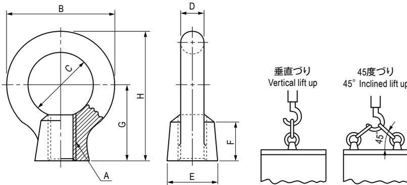
※45度つりの使用荷重は、ナットの座面が相手と密着し、2個のナットのリングの向きが左図のように同一平面内にある場合に適用します。
