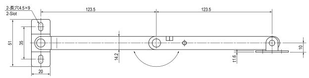
本図は左付を示したものです。 This figure shows for left side fixing type.
